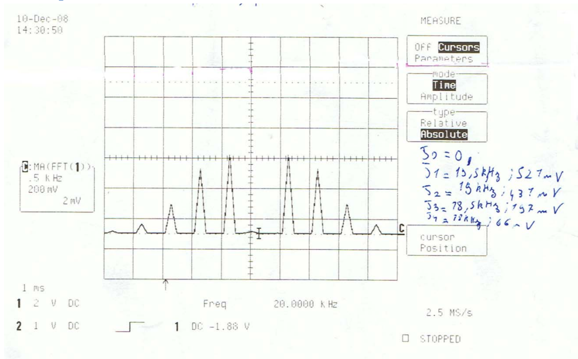
Figure 11 : Spectre avec un coefficient de modulation égal à 2,4
