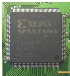
FIGURE 44 : EXEMPLE D'UN CIRCUIT FPGA
